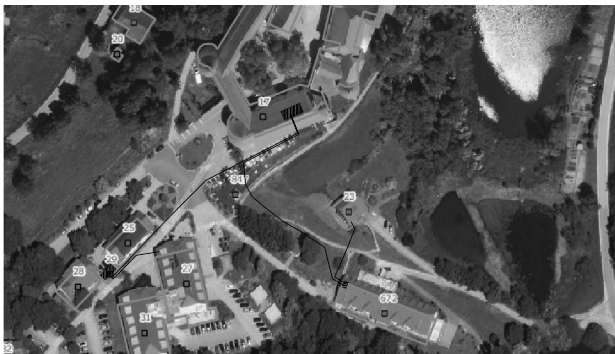
Slika 1: Prikaz obstoječega toplovodnega omrežja v zavodu Hrastovec
